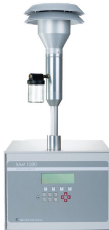
Figuur 1: De BAM 1020, automatisch meetsysteem waarmee in Nederland PM_{2,5} wordt gemeten.
